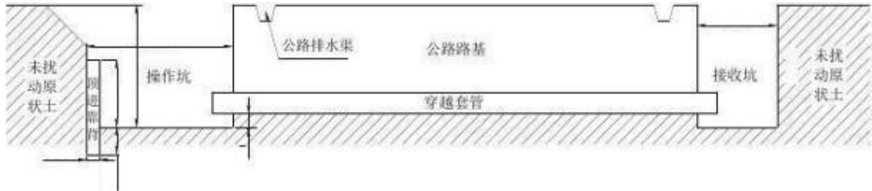
图3.3-5 穿越沥青道路施工作业示意图
