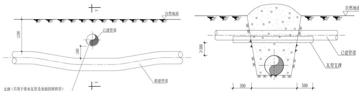
图 3.2-6 管道交叉施工作业示意图
