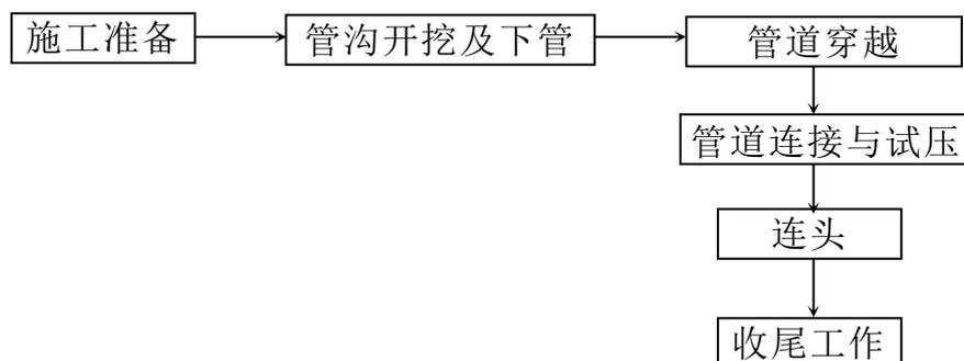
图3.2-3 施工方案工艺流程图
