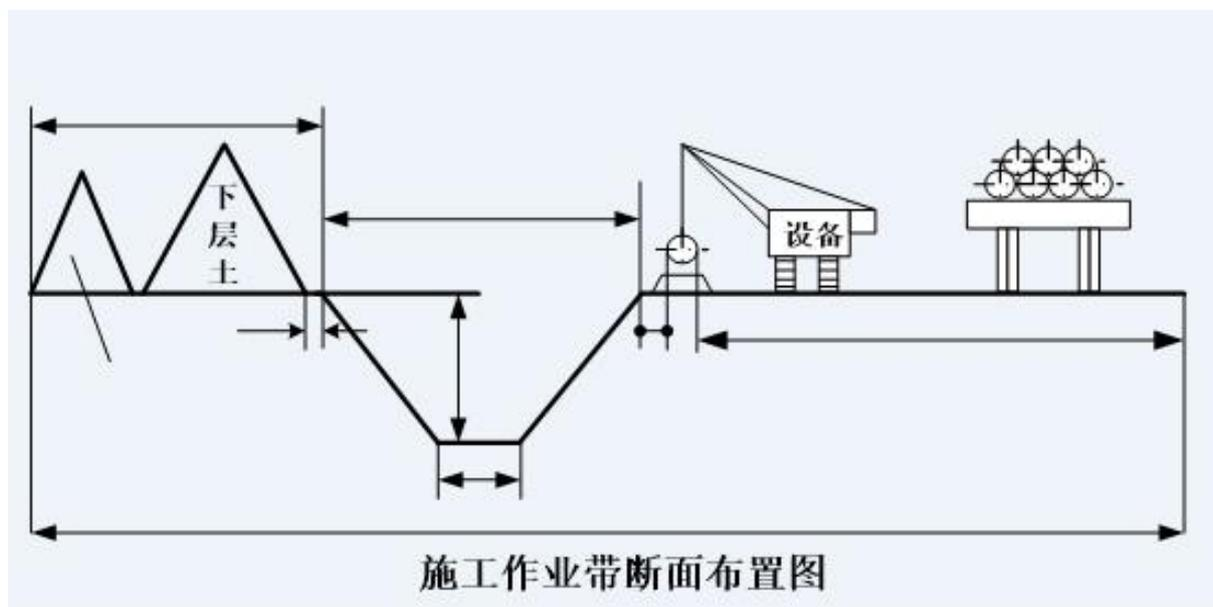
图 3.2-5 一般地段管道施工方式断面示意图
