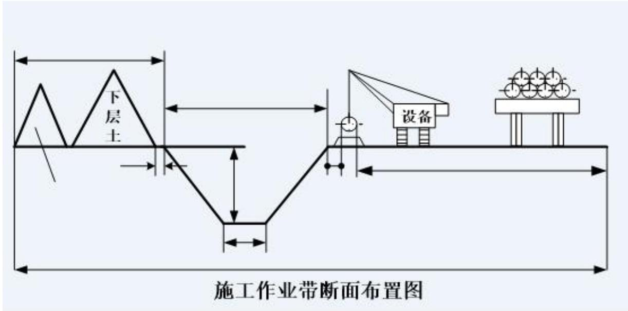
图 3.2-4 一般地段管道施工方式断面示意图
