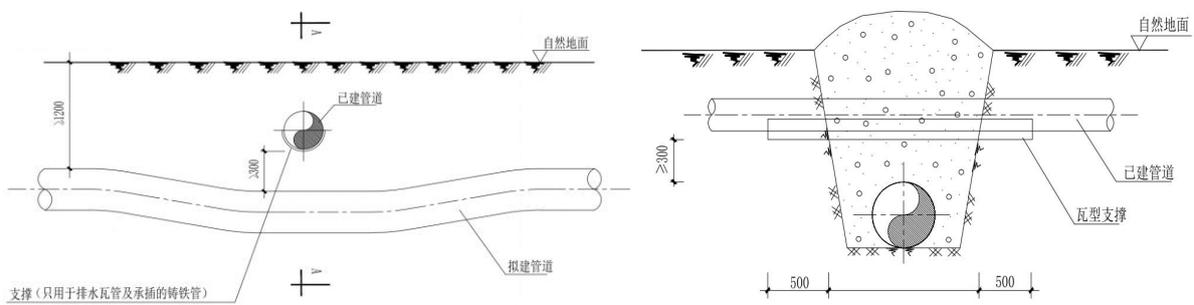
图 3.2-5 管道交叉施工作业示意图
