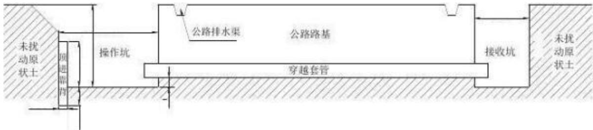
图 3.4-2 穿越道路施工作业示意图
