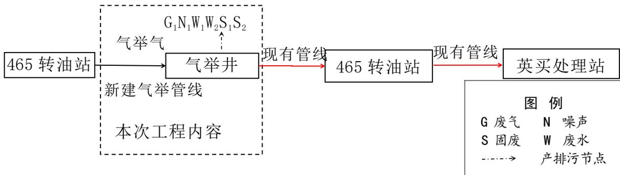
图 3.4-3 井场油气开采及集输工艺流程图
