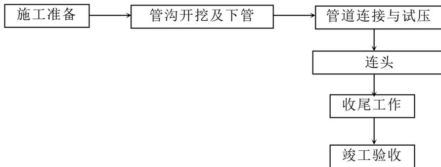
图 3.4-1 施工方案工艺流程图
